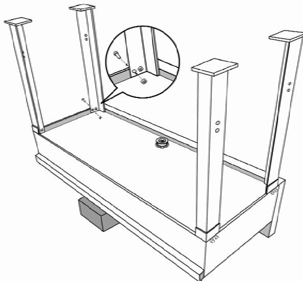
脚を4脚取り付けた後、下部補強枠とそれぞれの脚をボルト・ナットで固定して下さい。
