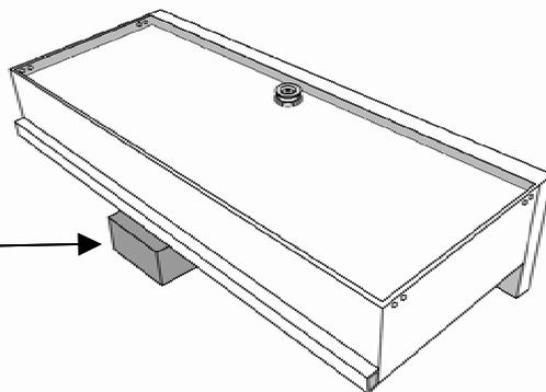
付属の脚を1脚ずつシンクに付属のナット・ボルトで確実に固定して下さい。
